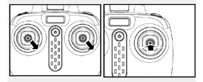
Квадрокоптер при включении всегда входит в «медленный» режим. Он намного удобнее и полезнее для того, чтобы набрать высоту или летать на небольшой высоте. Однако, производители предусмотрели и второй, «быстрый» режим, при котором аппарат намного энергичнее реагирует на команды пользователя и набирает скорость. Для входа в такой режим следует нажать на правый стик. Будет воспроизведен двойной звуковой сигнал, указывающий на вход в быстрый режим. Выйти из него можно точно таким же образом.
