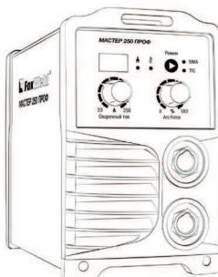
Инверторный сварочный аппарат Мастер 250 Проф предназначен для ручной дуговой сварки (MMA) любыми типами электродов, выполнен по новейшей IGBT технологии, позволяющей добиться минимального веса и габаритов. Отличается надежностью, хорошими техническими характеристиками, имеет программно-установленные функции HOT START, ANTI STICKING и регулируемый ARC FORCE, устойчиво работает при понижении напряжения сети (от 140 В), что делает аппарат более универсальным и практичным.
