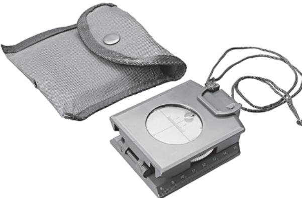
Жидкостный магнитный компас с уклонометром, фосфоресцирующей шкалой, визиром и прицельной нитью в металлическом корпусе. Компас DC60-1A брызгозащищен и предназначен для ориентирования на суше и на воде. По конструкции компас — жидкостный (раствор по составу близок к керосину), отличительной особенностью таких компасов является скорость
