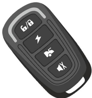
Брелок без дисплея используется в качестве резервного. Он не может принимать сигналы от системы, и предназначен только для формирования основных команд. Дальность действия брелка без дисплея в нормальных условиях находится в пределах 10 - 20 метров. Для индикации нажатия на кнопки служит светодиодный индикатор. Далее в тексте инструкции приведено описание управления системой только брелком с дисплеем.
